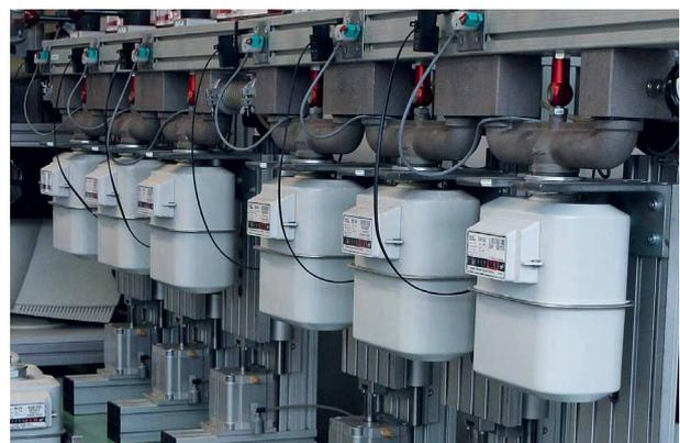
zusammengefasst werden, sofern sie unter vergleichbaren Einsatzbedingungen betrieben werden (z.B. gleiche Wasserqualität). Wohingegen in der Gasversorgung ein Los nur aus Zählern der gleichen Bauart, des gleichen Herstellers und der gleichen Zählergröße bestehen darf.
