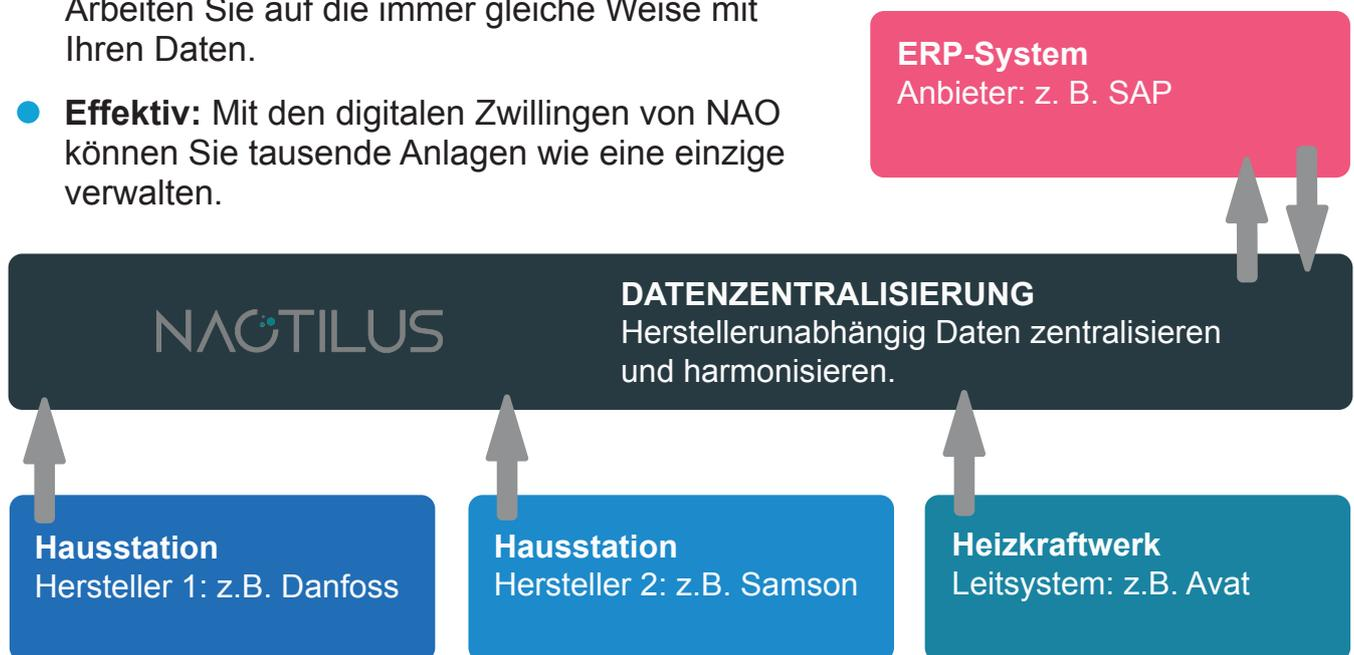
*Beispielanwendung: NAO zentralisiert IoT und Zählerdaten aus unterschiedlichen Systemen und kombiniert sie mit Daten aus dem ERP-System (z.B. Kunden- oder Nenndaten)*
