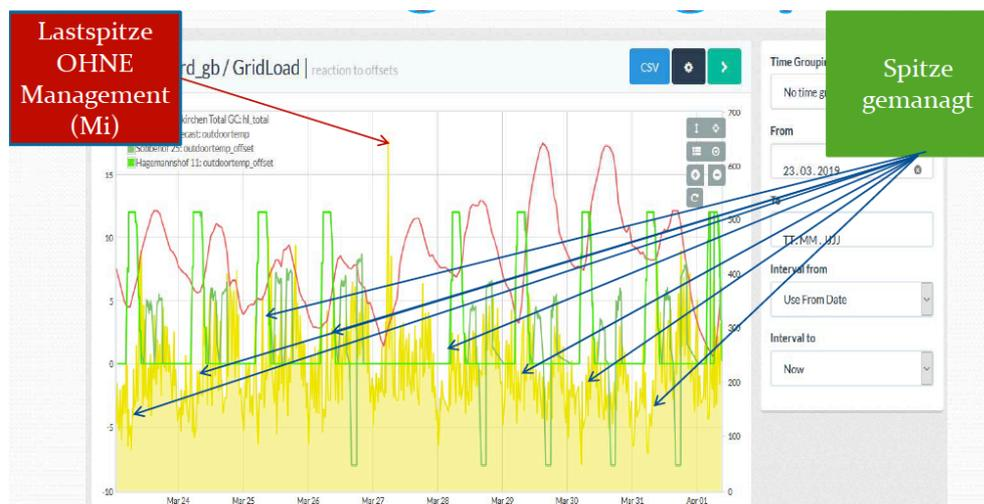
Abb. 5: Reduktion von Lastspitzen im DSM-Betrieb
